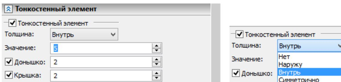
Для примитивов **Параллелепипед** и **Цилиндр** доступно задание донышка и крышки тонкостенного элемента.
